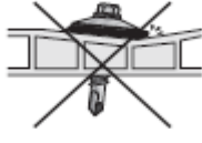
Kuva 13c Väärin – poraus ja asetus ei kohtisuorassa
