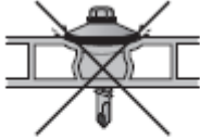
Kuva 13a Väärin – liiallinen kiristys
